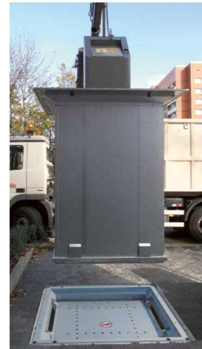
Geschlossene Sicherheitsplatte nach Anheben des Unterflurbehälters
