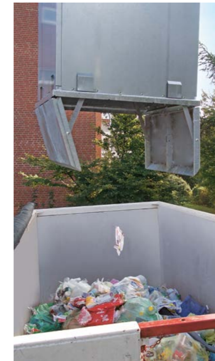
Leerung eines Unterflurbehälters über Ladefläche
